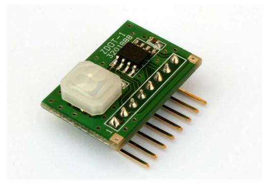
Figure 2. The ZMOTION<sup>TM</sup> Detection Module
