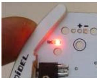
Pressez sur les moustaches, les LEDs s'allument lorsque les microswitch correspondants sont actifs.
